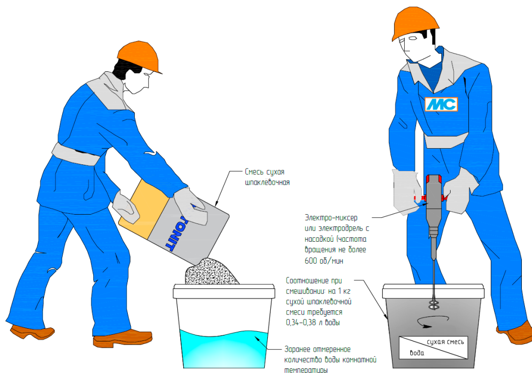
Рис. 28. Организация работ по затворению сухой шпаклевочной смеси
